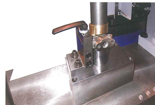
ポンプフランジ面加工
