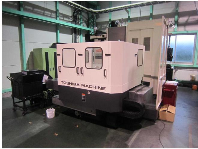
上の写真は先月まで弊社主力設備として活躍していた安田機械製NC横型中ぐり盤「YBM-60N」に代わり新規設備した東芝機械製「BTD-100-R10」です。
